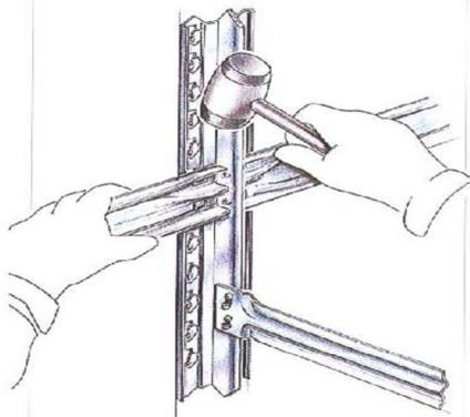
Insérez les lisses dans les encoches (fente vers le haut) des montants en les tenant perpendiculairement aux montants. Tapez ensuite de haut en bas à l'aide d'un maillet sur la lisse et ce le plus près possible du montant. Utilisez de préférence un maillet à embout plastique pour éviter d'endommager les lisses.
